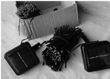
Le catene con le minuscole luci a LED, alimentate a energia solare, i pannelli hanno una dimensione di circa 6 per 6 cm che saranno fissati su alcuni rami di alcuni alberi nel luogo previsto (circa 50 pezzi).
